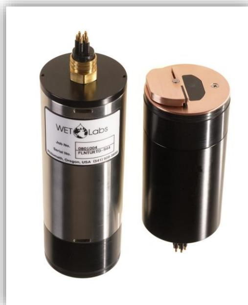
ECO-FL 蛍光光度計は、クロロフィル-a、CDOM、ウラニン、ローダミン、そしてフィコシアニンとフィコエリトリンから蛍光を測定します。
